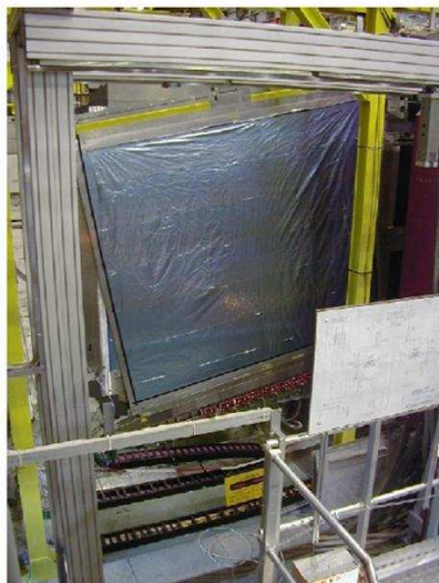
Figura 2.15: Uno straw a doppio strato montato nello spettrometro di COMPASS; si può notare il rivestimento con un foglio di alluminio-Mylar che protegge l'apparato dall'umidità dell'ambiente.
