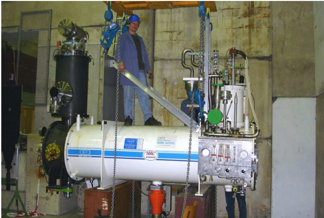
Figura 2.4: Fotografia del sistema di polarizzazione del bersaglio usato fino al 2004.
