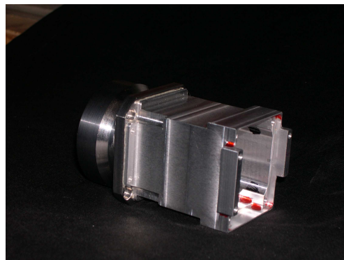
Figura 4.33: Vista posteriore del prototipo definitivo. A montaggio finito viene posizionato un "tappo" di larghezza pari alla distanza tra i connettori del MAPMT.
