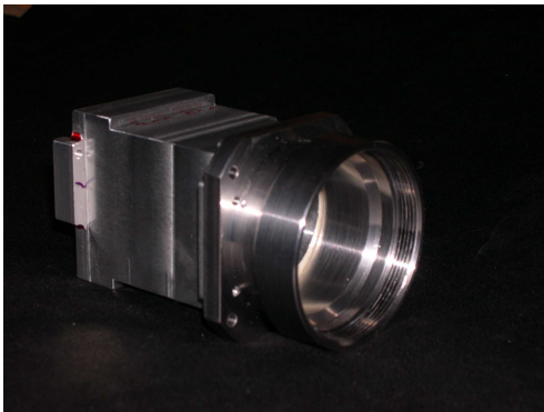
Figura 4.32: Vista frontale del prototipo definitivo prodotto da un blocco unico di ferro dolce. La parte di supporto per le lenti viene successivamente avvitata; da notare che la sagomatura della parte cilindrica ha lo scopo di utilizzare meno ferro possibile in modo a rendere più leggera la struttura.
