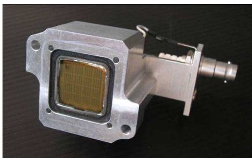
Figura 4.1: Visione frontale del MAPMT inserito già nel supporto metallico con annesso partitore resistivo per l'alimentazione.
